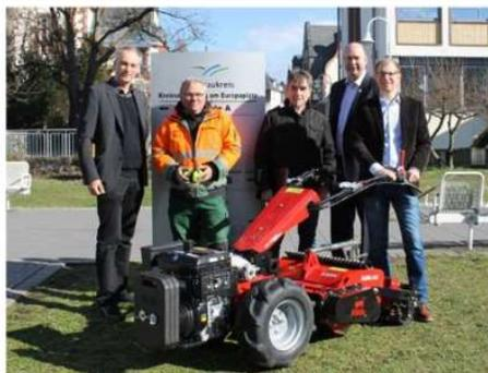
Neue Maschine mit Umkehrfräse für Saatbettvorbereitung (Foto: M. Elsaß)
