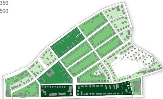
Potenzial durch Wärmebedarfsreduzierung (Sanierung) auf Baublockebene
