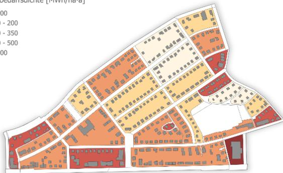
Wärmebedarfsdichte auf Baublockebene
