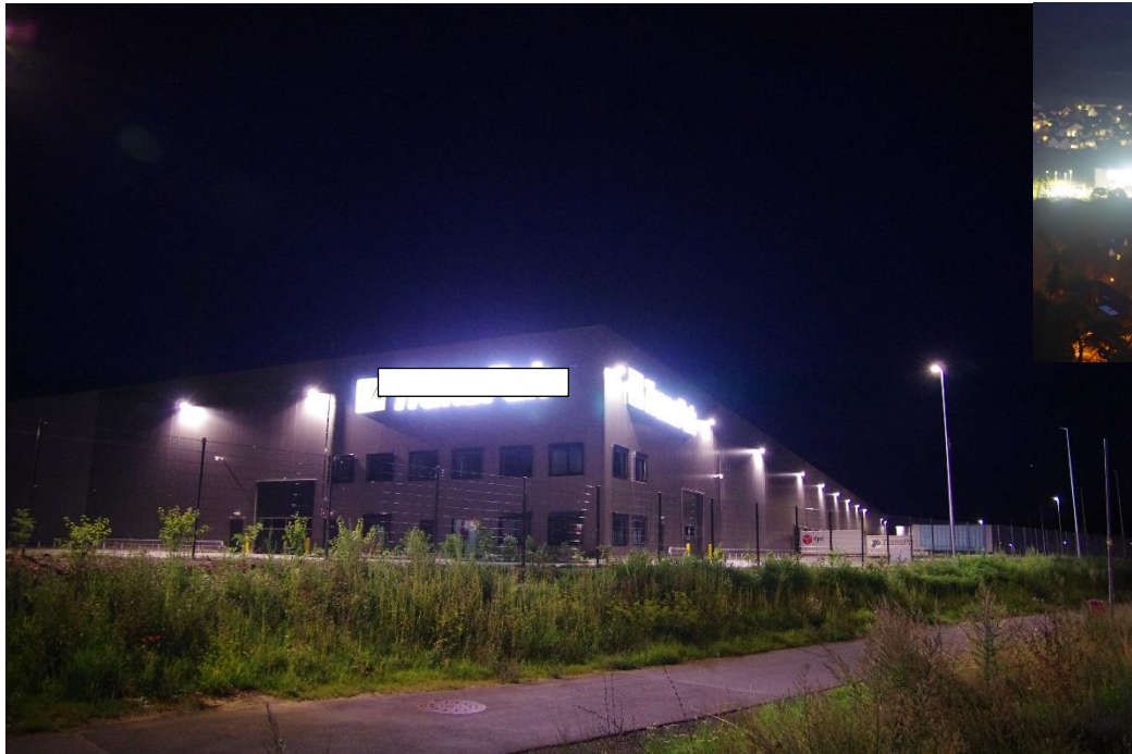
Oben: Auch hier sind die Anbringungshöhen neben der Farbtemperatur und Lichtmengen falsch gewählt. Die Leuchtdichte des Werbelichts ist zu hoch und sorgt für eine negative Veränderung des Ortsbild. Foto: Th. Düring
